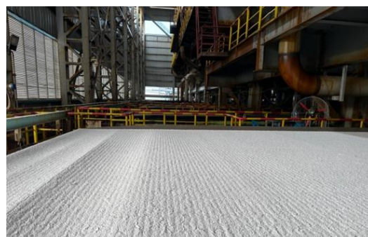
図7. 選鉱で得た塩化加里の乾燥 (アジア加里より引用)
