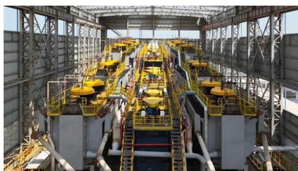
図6. 採掘された加里鉱石の浮遊選鉱工程 (アジア加里より引用)
